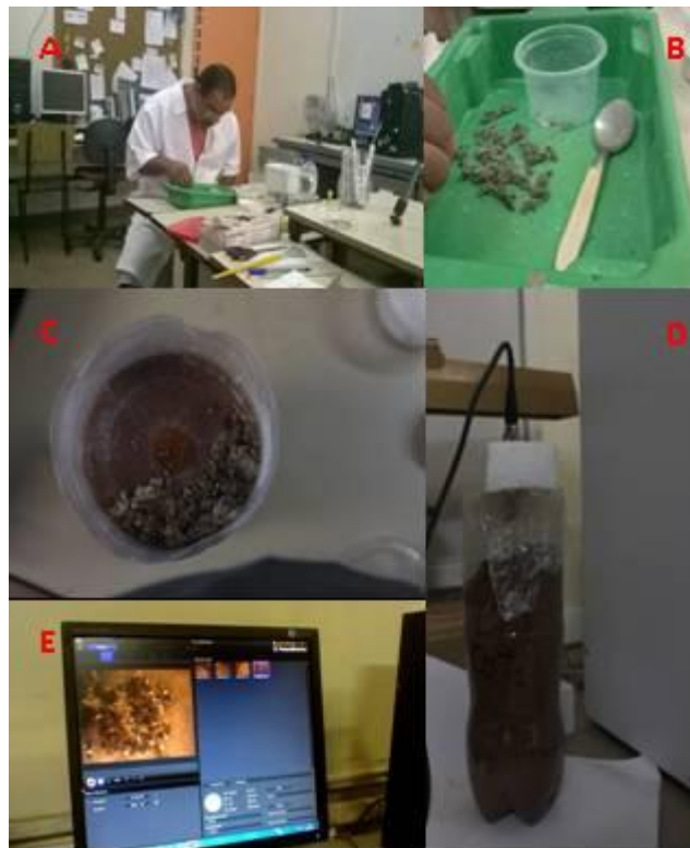
Figura 2. Set up experimental para o registro da atividade de escavação das operárias de A. subterraneus : A e B) Coleta de fungo simbiote e prole; C) Disposição da prole, jardim de fungo e operárias no recipiente de observação; D e E) Câmera de vídeo acoplada ao cilindro de escavação. Fonte: Carlos Magno dos Santos, 2014.
