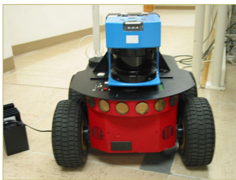
Figura 9: Sensor SICK LMS-200 Acoplado ao Pioneer P3-DX
