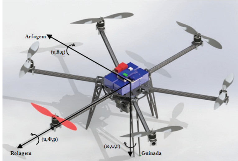
Figura 10: Definição das variáveis de estados nos eixos de medições.
