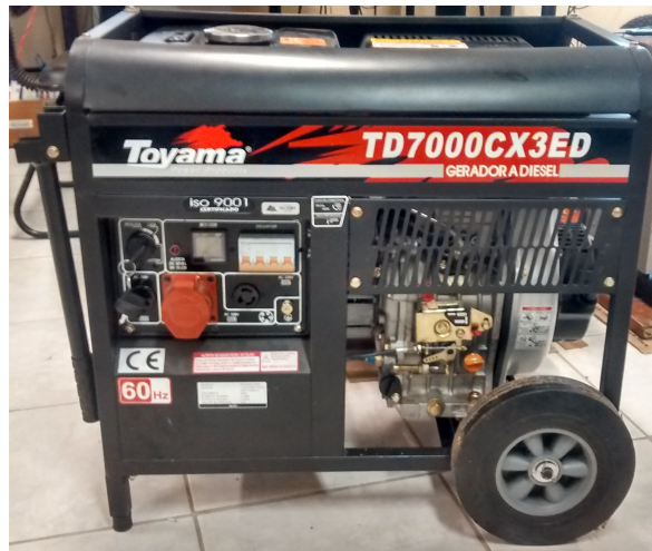
Figura 2: Fotografia do gerador à diesel de 5,5 kW modelo TD7000CX3ED, fabricado pela empresa Toyama e disponível no NAEP.
