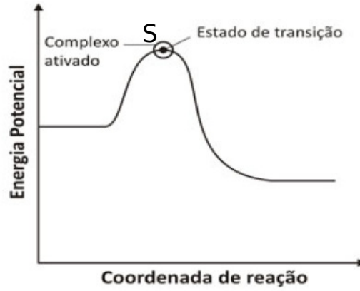
Figura 2.1: Curva de Energia potencial para reação com transição de estado contendo uma transição de estado no topo da barreira \Delta S , referência [41], página 4.
