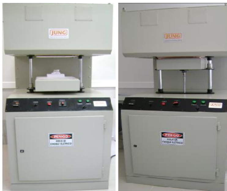
Figura 5.4 – Visão frontal do forno Jung (modelo LF0916) utilizado no processo de fusão das amostras vítreas pertencente ao CPV - UFJF.
