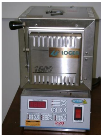
Figura 5.7 – Mufla EDG modelo Logen Scientific utilizada nos processos de annealing e tratamento térmico das amostras pertencente ao CPV - UFJF.
