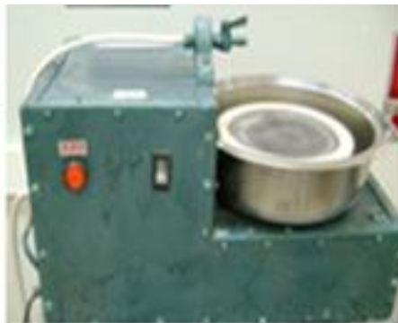
Figura 5.8 – Politriz utilizada nos processos de lixamento e polimento das amostras pertencente ao CPV – UFJF.
