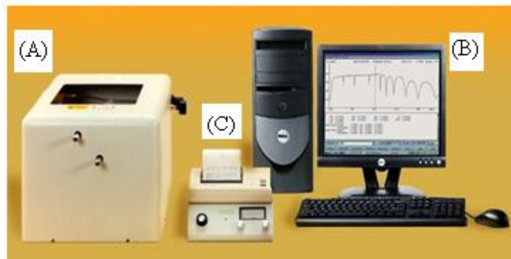
Figura 5.15 – Equipamento para medida do IRL ( Metricon ) (A) Módulo Óptico, (B) Microcomputador e (C) Controlador de rotação [60].
