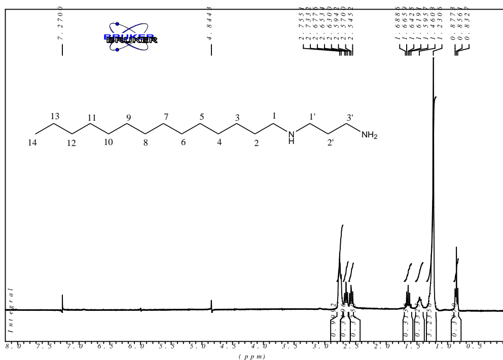
Figura 1.56. Espectro de RMN de ^1\text{H} de 30d (CDCl 3 , 300MHz).
