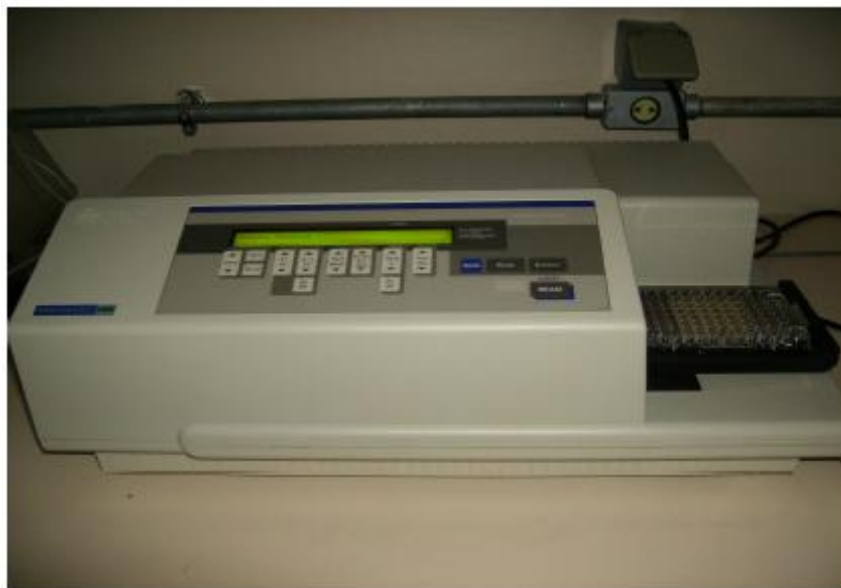
Figura 1.64. Leitor de microplacas Spectramax, utilizado no Método do MTT e no Método de Griess.
