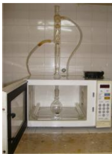
Figura 1.25. Aparelho de forno de micro-ondas doméstico adaptado para síntese.
