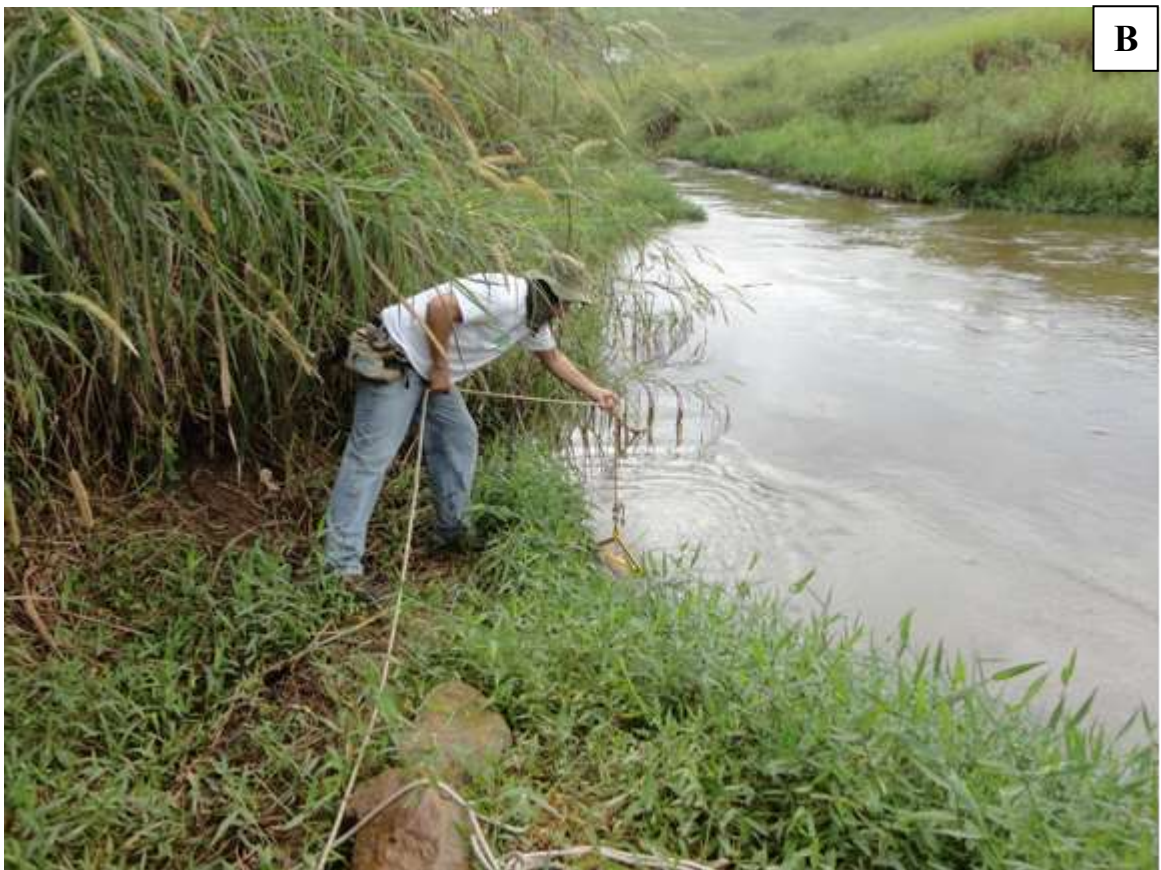
Figura 7: Fotos do procedimento de coleta de sedimento do rio Paraibuna para análise de HPAs e metais lançando a draga de Petersen (A) de cima de uma ponte e (B) da margem do rio.
