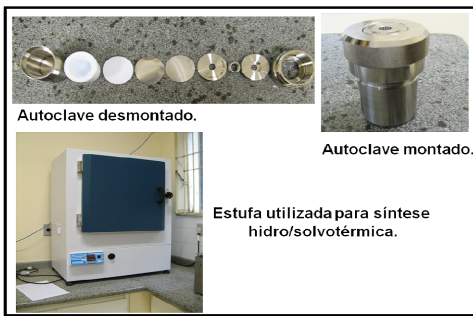
Figura 3.4 Equipamentos utilizados na síntese hidro/solvotérmica.
