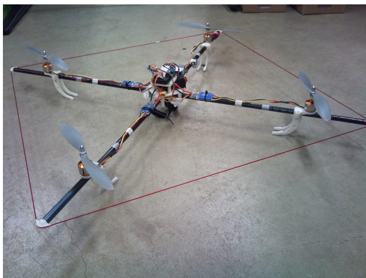
Figura 3.2: Imagem do Protótipo do Quadrotor Flying 4U
