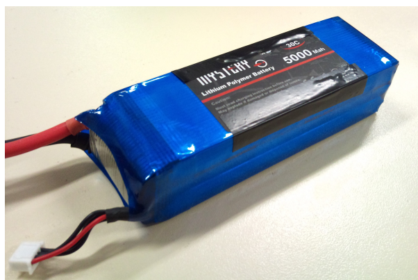
Figura 3.7: Foto de Bateria Li-Po: 11,1 V, 5000 mAh e 30 C
