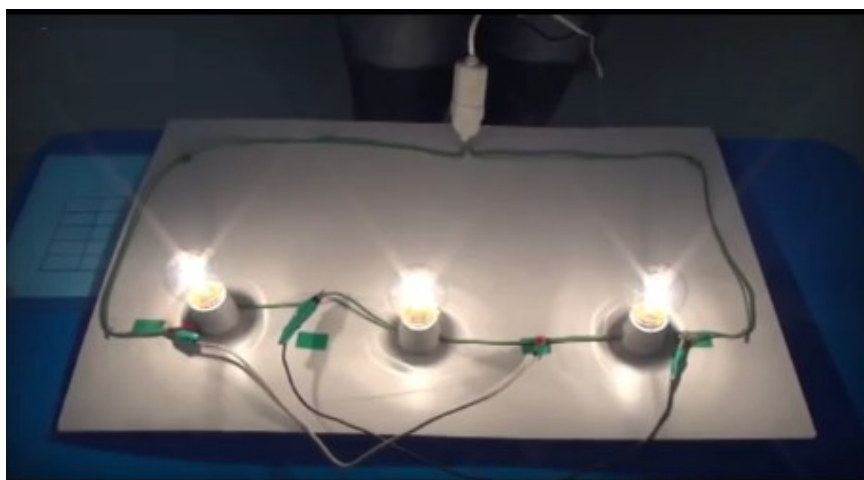
Figura 5.1: Aparato experimental para ensinar associação de resistores em série e em paralelo. [https://www.youtube.com/watch?v=7Di6xrl2J0s&t=28s]
