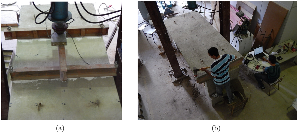
Figura 3.6: Esquema experimental da laje. (a) Sistema de transmissão da carga por macaco hidráulico; (b) Aquisição dos dados.
