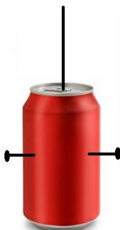
Figura 3 – latinha com os dois furos laterais suspensa por barbante
