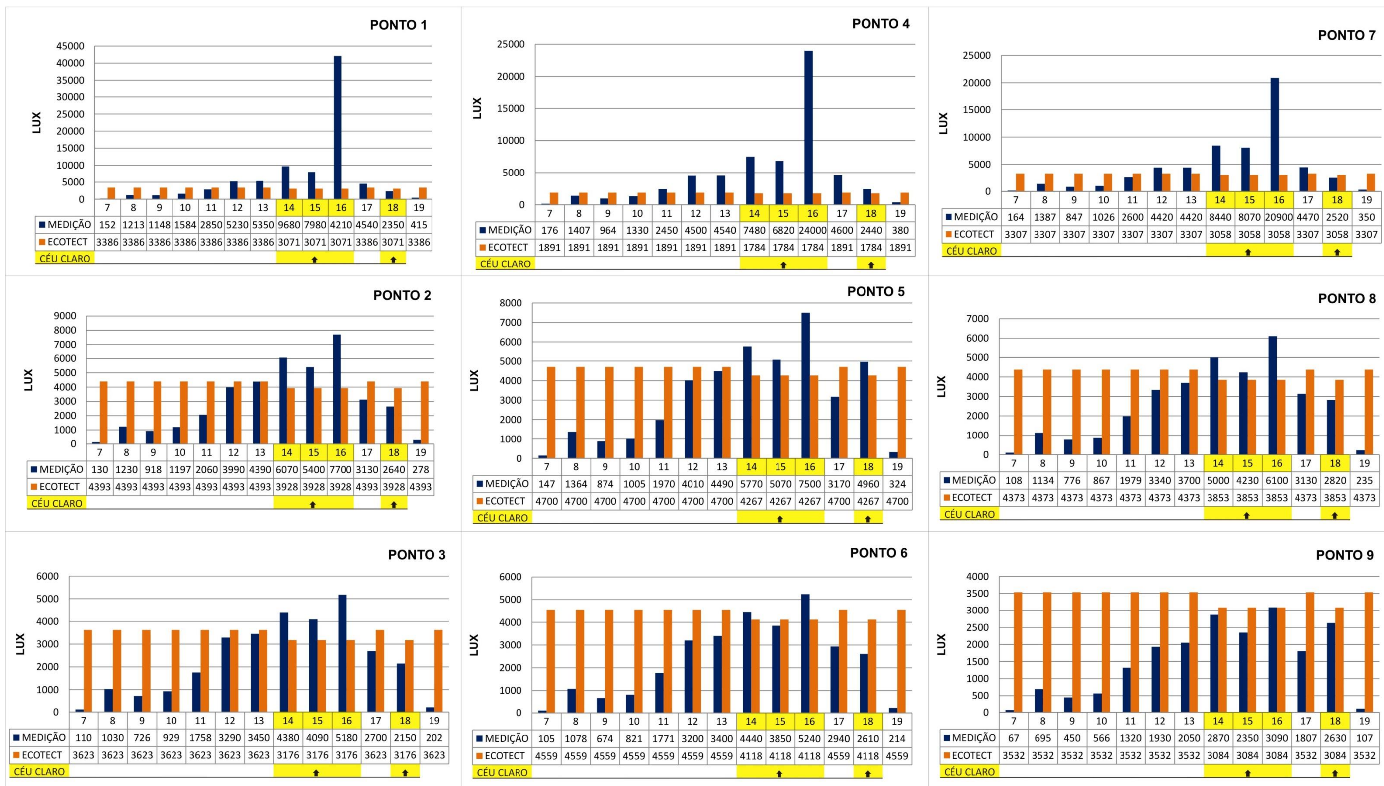
Figura 45 – Medição x Ecotect™. Comparação das iluminâncias provenientes de medição e de simulação para o dia 17 de fevereiro de 2011 em condição de céu encoberto e claro.
