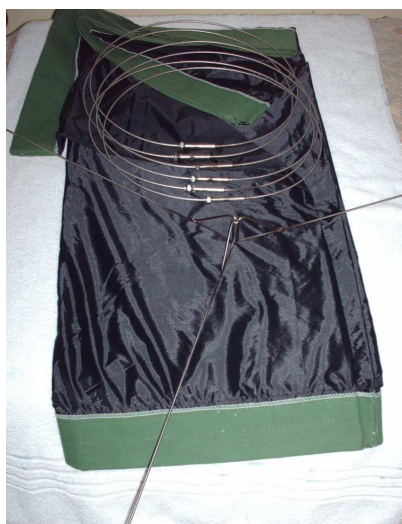
Fotografia 3 – Parte imersa (vela de arrasto) desmontada.
