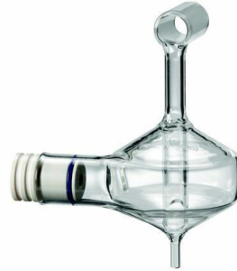
Figura 2. Imagem da câmara de nebulização utilizada no equipamento de ICP-AES
