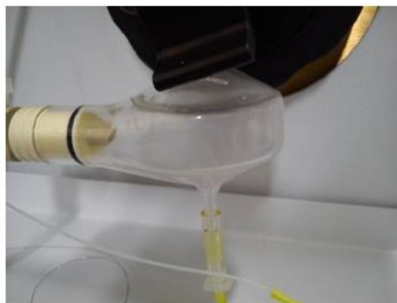
Figura 18. Sistema de nebulização com a proporção (1:2) de diluição das amostras durante uma medida.
