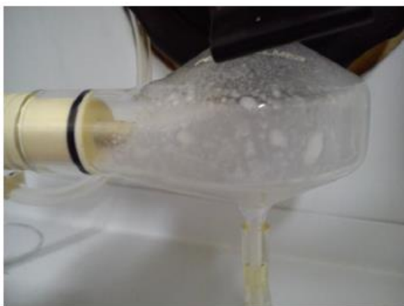
Figura 17. Sistema de nebulização com a proporção (1:1) de diluição das amostras durante uma medida.
