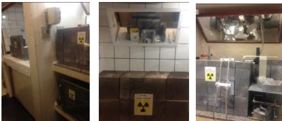
Figura-4.5: Área de manipulação de armazenamento da cápsula selada. A esquerda tem a vista da capela química, capela de manipulação e cofre de chumbo para armazenamento do ^{22}\text{Na} . Na figura central tem-se a capela química e na figura á direita, a capela de armazenamento.
