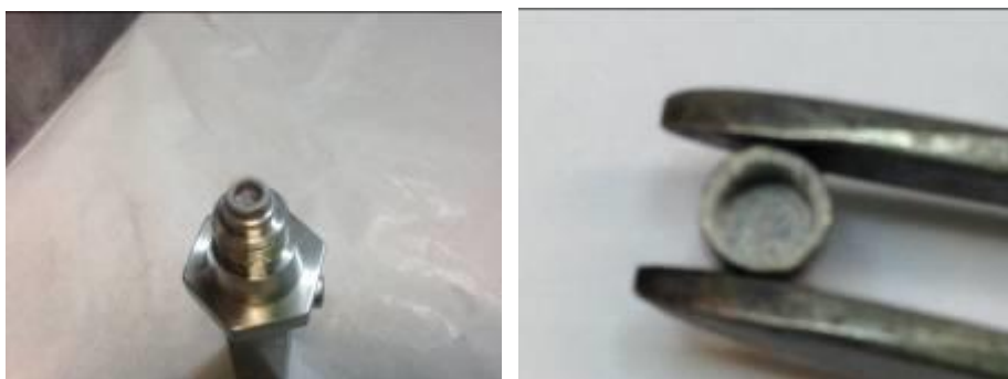
Figura-4.14: Testes iniciais de carregamento e secagem com a solução não radioativa de NaCl.
