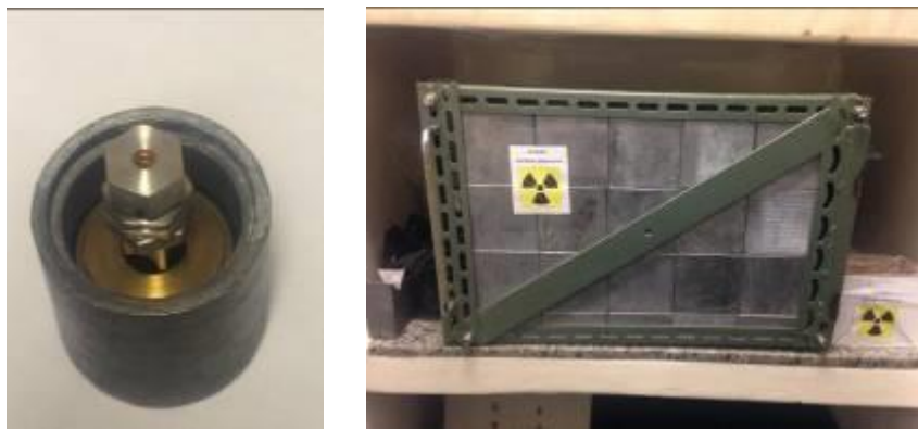
Figura-4.18: Recipiente de chumbo para o armazenamento da cápsula e o castelo de chumbo destinado ao armazenamento de elemento radioativo.
