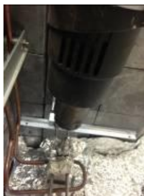
Figura-4.9: Espelho redondo usado para visualizar o carregamento. Lâmpada de infravermelho e canhão de calor, ambos usado para secagem da gota de NaCl.
