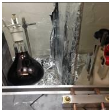
Figura-4.9: Espelho redondo usado para visualizar o carregamento. Lâmpada de infravermelho e canhão de calor, ambos usado para secagem da gota de NaCl.
