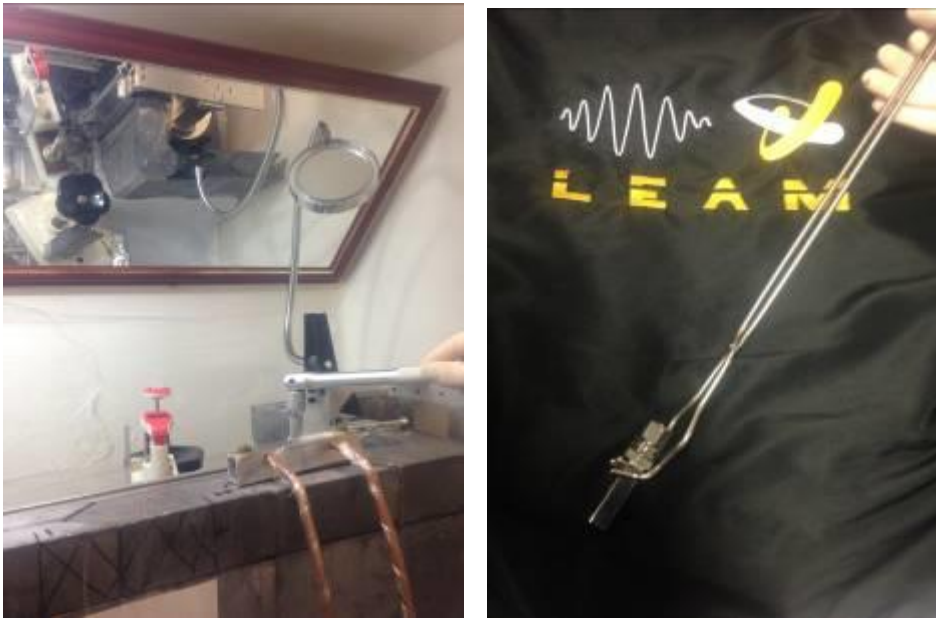
Figura-4.16: Procedimento de selagem e as condutas para a retirada da cápsula após a selagem.
