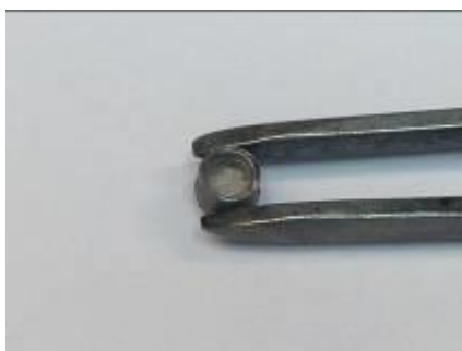
Figura-4.15: Formação da deposição correta do sódio não radioativo no interior do copo de Ta.
