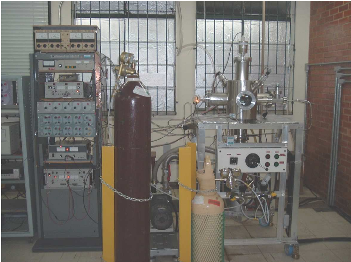
Fig. 3.1: Aparelho de medidas de Secções de Choque Total do espalhamento de Elétrons por alvos gasosos.
