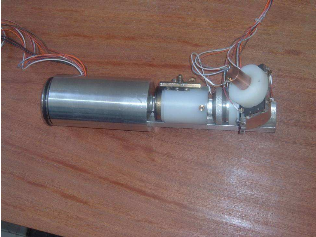
Fig. 3.3: Elementos do aparelho de medidas de SCT instalados no interior da câmara de alto vácuo. Da esquerda para direita observa-se o canhão de elétrons (instalado numa câmara para bombeamento diferencial e blindagem eletrostática), a célula gasosa, o analisador de energia e coletor de Faraday.
