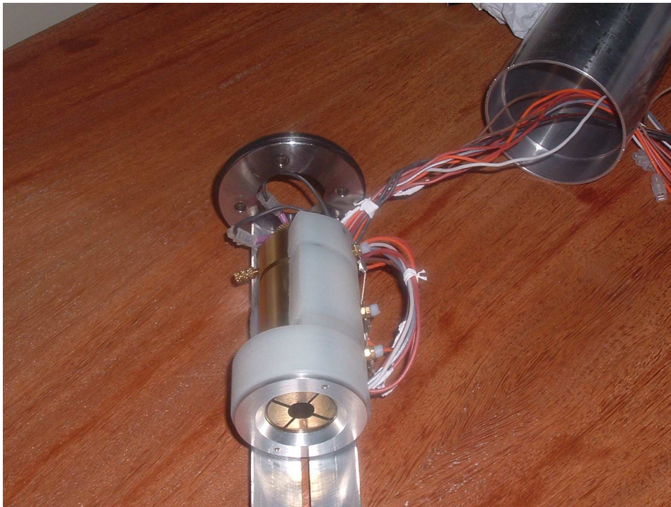
Fig. 3.4: Canhão de elétrons aplicado na Técnica de Transmissão Linear. O canhão produz feixes eletrônicos com energias variáveis na região de 60 a 500 eV e resolução energética em torno de 600 meV.
