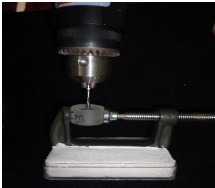
FIGURA 6 – Cp posicionado na morsa para torque de fechamento CM.
