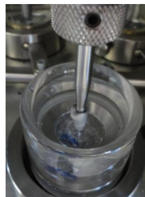
FIGURA 15 – Corpo de prova Posicionado no pistão.
