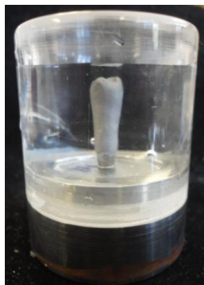
FIGURA 14 – Corpo de prova Inserido no suporte.
