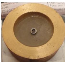
FIGURA 5 – Cilindro de cobre com resina acrílica e implante inserido no centro.
