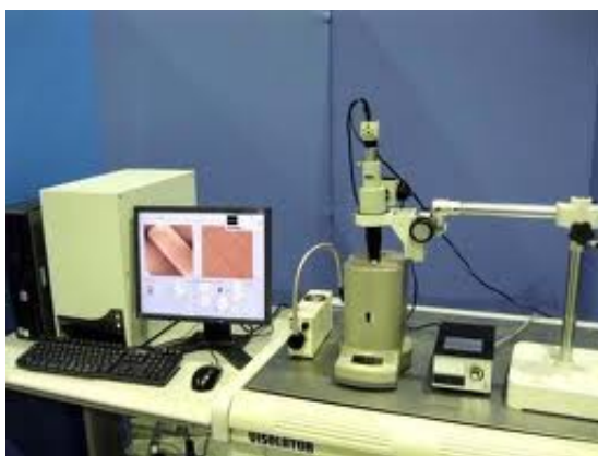
Figura 3.7 – Microscópio da Shimadzu (SPM-9600) usado na técnica de AFM.
