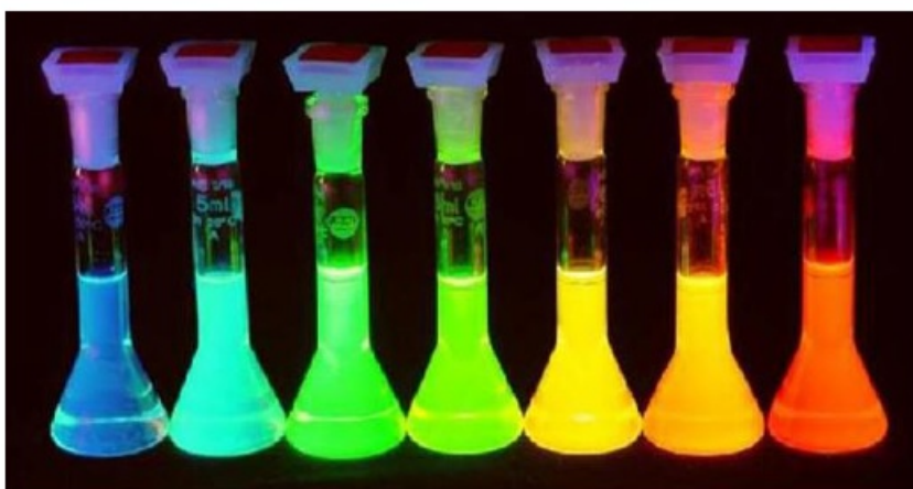
Figura 2.15 – Emissão de soluções contendo nanopartículas semicondutoras; O tamanho das nanopartículas cresce da esquerda para direita (CARMO, 2011).
