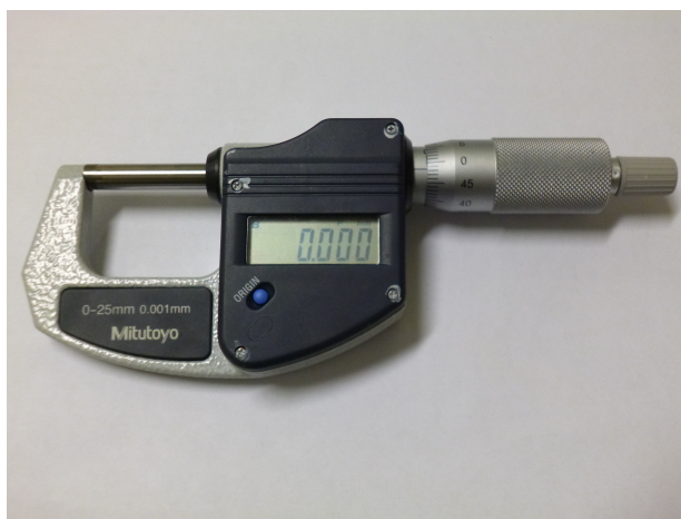
Figura 3.3 – Micrômetro digital da Mitutoyo Products utilizado para obtenção da espessura das amostras.
