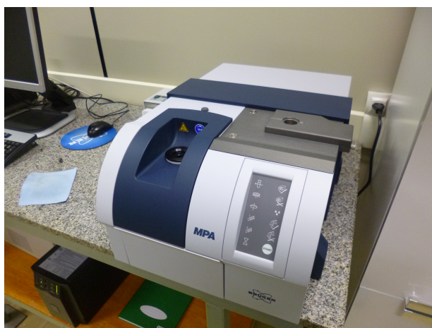
Figura 3.10 – Espectrômetro FT-NIR, modelo MPA da Bruker Optics .
