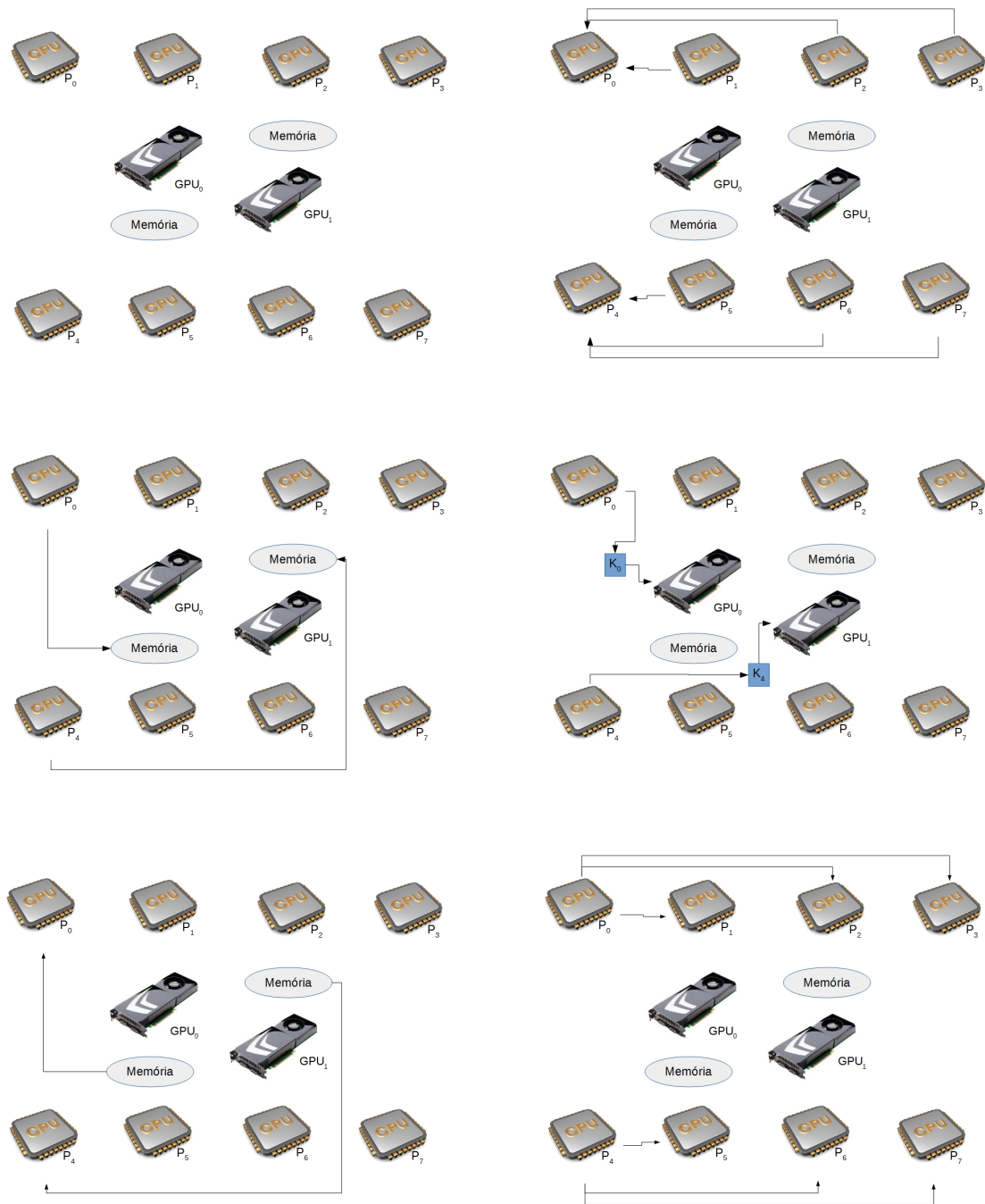
Figura 4.3: Ilustração do método KA. Os demais processos do grupo enviam seus dados para o processo 0 que, por sua vez, faz a cópia dos dados na memória da GPU. O processo 0 executa o kernel e, logo depois, copia o resultado da memória da GPU. Por fim os dados são espalhados entre os demais processos do grupo.
