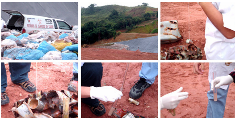
Fotografia 1. Coleta de amostras de chorume da pilha de resíduos de serviço de saúde (RSS) no aterro sanitário da cidade de Juiz de Fora, MG.
