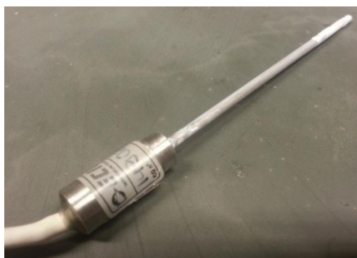
Figura 12. À esquerda, o PT100 da marca Ecil. À direita, gráfico da resistência do PT100 em função da temperatura, conforme dados no manual do fabricante.
