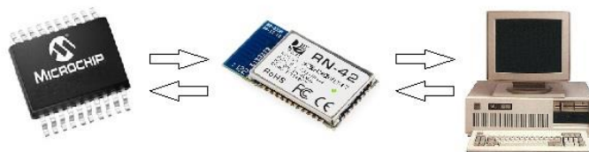
Figura 8. Trânsito de informações entre o “software” no PC e o microcontrolador PIC18LF1220 (Microchip™), passando pelo módulo Bluetooth®.
