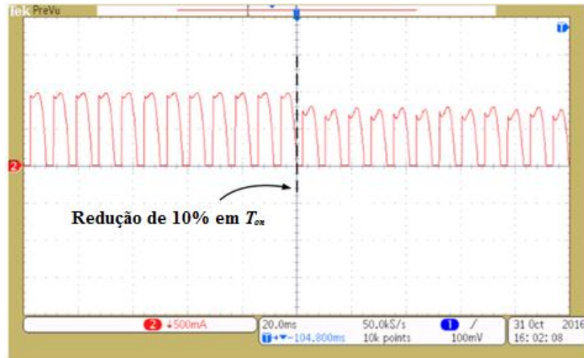
Figura 4.5 : Resposta do protótipo do driver de baixa frequência a um degrau de menos 10% em T_{on} . Escala do Osciloscópio: 500 mA/div e 20ms/div.
