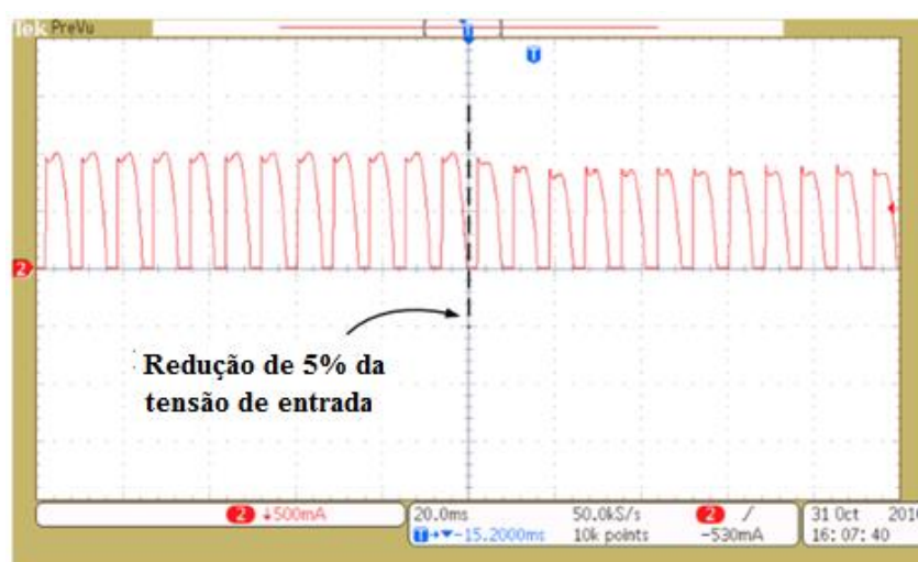
Figura 4.4: Resposta do protótipo do driver de baixa frequência a um degrau de menos 5% na tensão de entrada. Escalas do Osciloscópio: 500 mA/div e 20ms/div.
