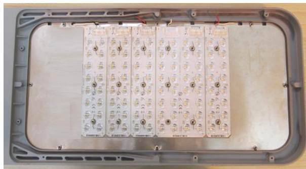
Figura 3.6: Arranjo de 96 LEDs Philips Luxeon R LXA7PW40 associados em série.
