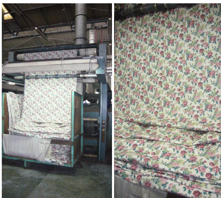
Figura 58: Detalhes do tecido saindo após ser estampado ao final da máquina Regianni e sendo acomodado em carrinhos de madeira - CTFG (Fotos Claudia Gaspar Cimino, 2013).
