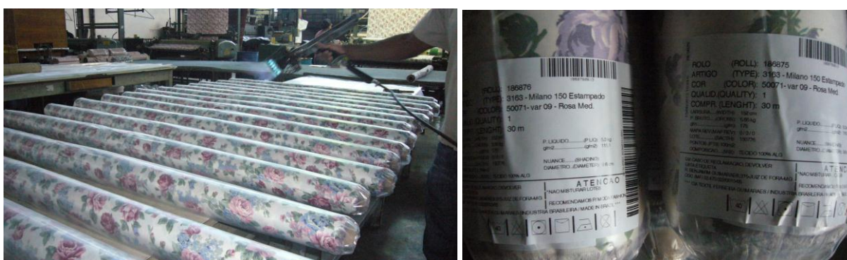
Figura 63: Rolos de tecido na Sala do Pano da Acabadora CGF sendo plastificados e etiquetados – Desenho Rosa Médio (Fotos Claudia Gaspar Cimino, 2013).
