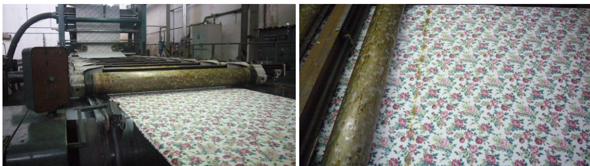
Figura 57: Detalhes do tecido sendo estampado na máquina Regianni - CTFG (Fotos Claudia Gaspar Cimino, 2013).
