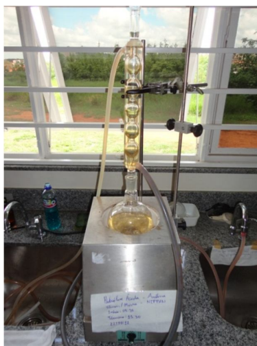
Figura 23. Hidrólise sob refluxo da substância AL-D III 5*. Fonte: Núcleo de Investigação e Pesquisa de Produtos e Ativos Naturais (NIPPAN) - Faculdade de Farmácia/UFJF. Foto: Autora (2013).
