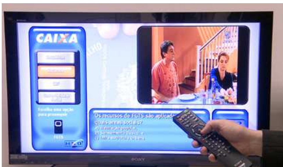
Figura 3 – Exemplo de conteúdo interativo para TV, desenvolvido por meio do middleware Ginga. Fonte: Ministério das Comunicações (disponível em: http://www.mc.gov.br/telecomunicacoes-new/noticias-telecomunicacoes/26190-minicom-lanca-ginga-brasil-para-estimular-interatividade-na-tv-digital )
