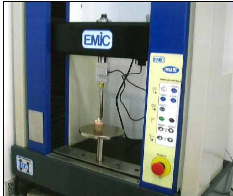
Figura 4 – Fotografia da máquina universal de ensaio EMIC modelo DL 2000 (Faculdade de Odontologia – UFJF).
