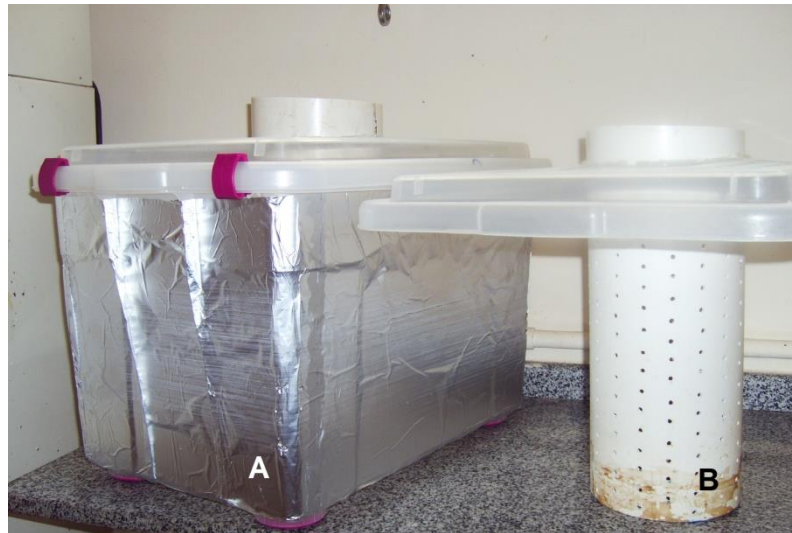
Figura 7. A, gaiola usada para acomodar os animais durante os experimentos; B, tampa com tubo PVC acoplado, dentro do qual o aparelho celular permanece alojado durante o período de exposição.
