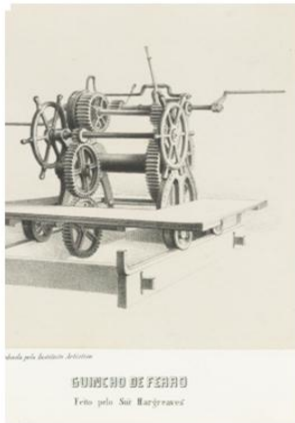
Figura 11: Guincho de ferro fundido (produto fabricado e exposto por Henrique Hargreaves na exposição de 1861)
