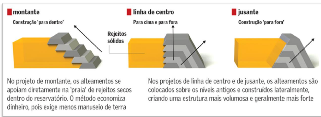
Figura 2. Métodos de construção de barragens de rejeito
