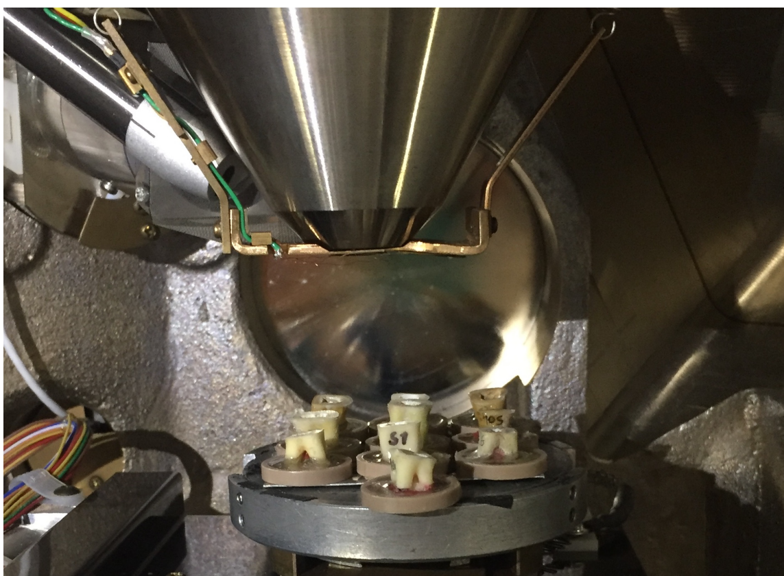
Figura 6 – Amostras posicionadas para análise no microscópio eletrônico de varredura.
