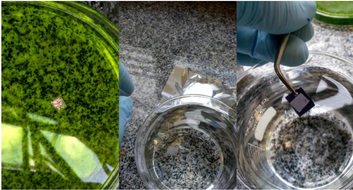
Figura 5.2 Principais etapas do processo de transferência dos filmes de grafeno. À esquerda o filme de grafeno + PMMA é corroído pela solução de ( FeCl_3 + HCl ). Em seguida, o filme de grafeno + PMMA (centro da figura) é retirado da solução e colocado/transferido para seis banhos com água DI. Por fim (quadro à direita), o grafeno é “pescado” com substrato final de seu interesse, normalmente substrato de Si/SiO_2 com 300 nm de SiO_2 .
