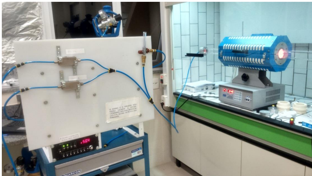
Figura 4.4- Fotografia do sistema CVD usado para crescer poucas camadas de grafeno no laboratório de materiais de carbono na UFJF.
