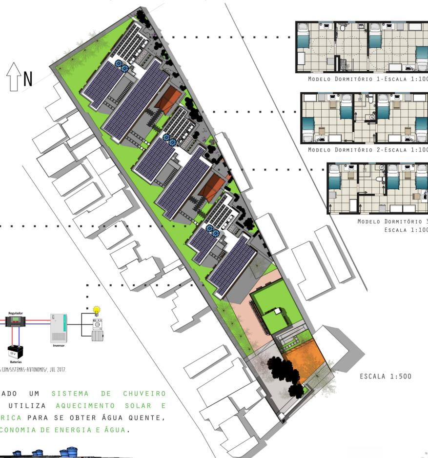
A ÁGUA PROVENIENTE DE TODA A ÁREA IMPERMEABILIZADA LOCALIZADA NA COBERTURA E PAVIMENTO TÉRREO, SERÁ DIRECIONADA E CONDICIONADA EM UMA CISTERNA LOCALIZADA NO SUBSOLO, SENDO BOMBEADA PARA OS RESERVATÓRIOS MENORES LOCALIZADOS NA COBERTURA DOS EDIFÍCIOS, SENDO, POSTERIORMENTE, REUTILIZADA NAS DESCARGAS E REGA DAS PLANTAS.
