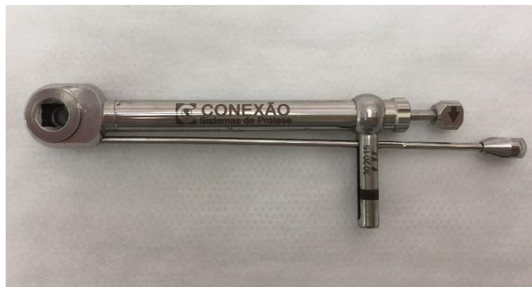
Figura 7: torquímetro manual (Conexão Sistemas de Prótese®). Fonte: autor.
