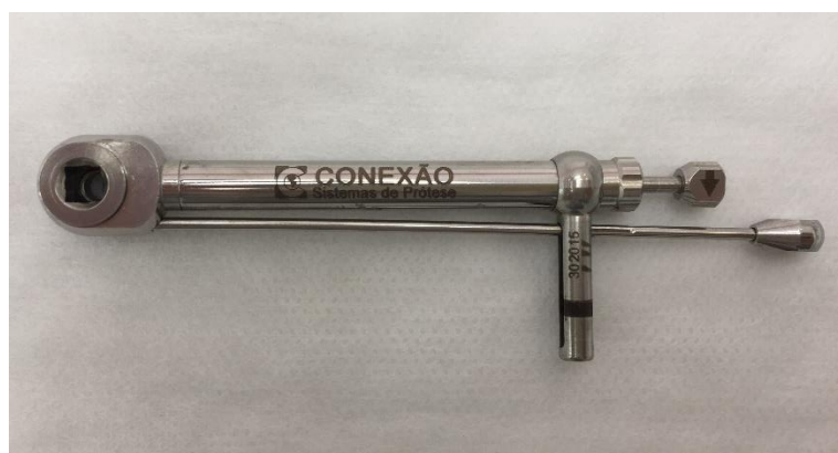
Figura 5: torquímetro manual (Conexão Sistemas de Prótese®). Fonte: autor.
