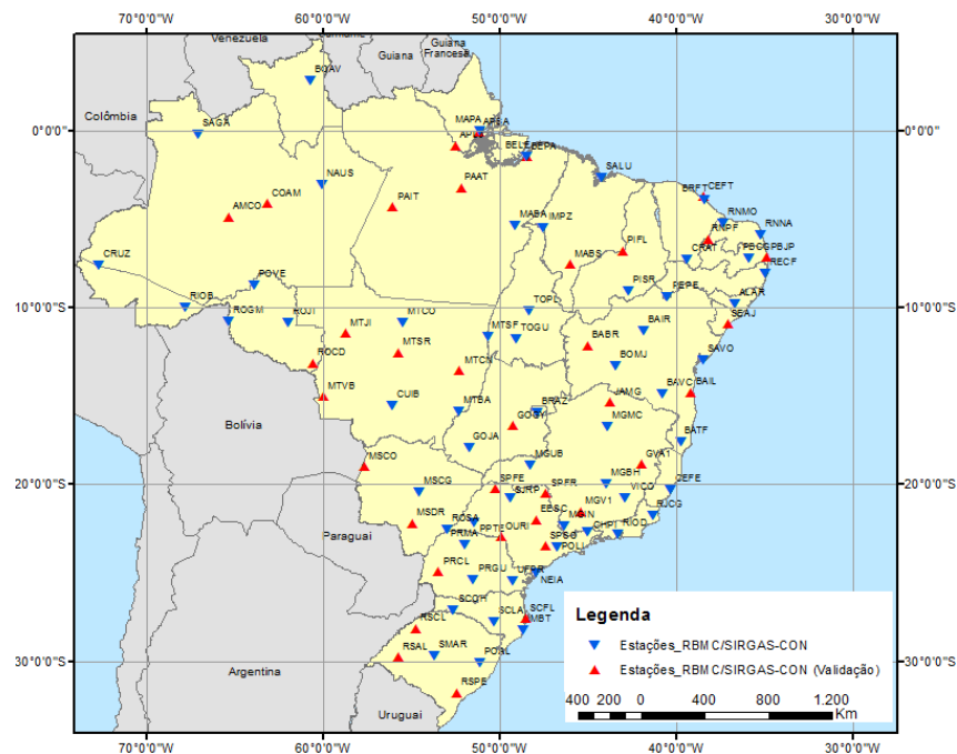
Figura 36 - Estações da RBMC empregadas na estimação e validação interna e externa dos parâmetros de transformação.
