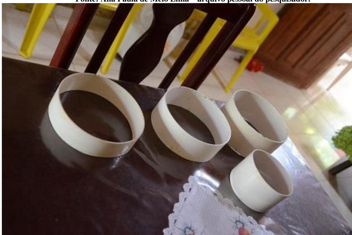
Figura 22 - Fôrmas de PVC, elaboradas a partir do corte de um cano de água.
