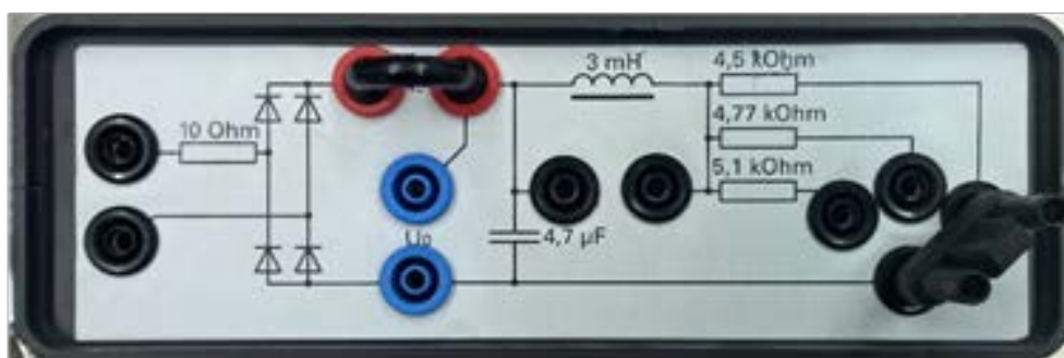
Figura 72: Dispositivo utilizado para definir a carga não linear.
