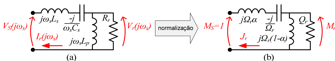
Figura 3.32 – Análise no domínio da frequência do filtro ressonante LLC série-paralelo para a componente fundamental da tensão de entrada: (a) circuito original e (b) circuito normalizado.
