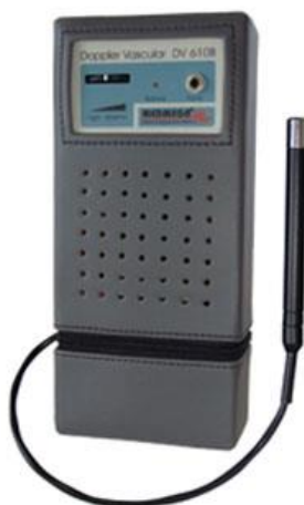
Figura 4: Aparelho doppler vascular. Fonte: arquivo do pesquisador.
