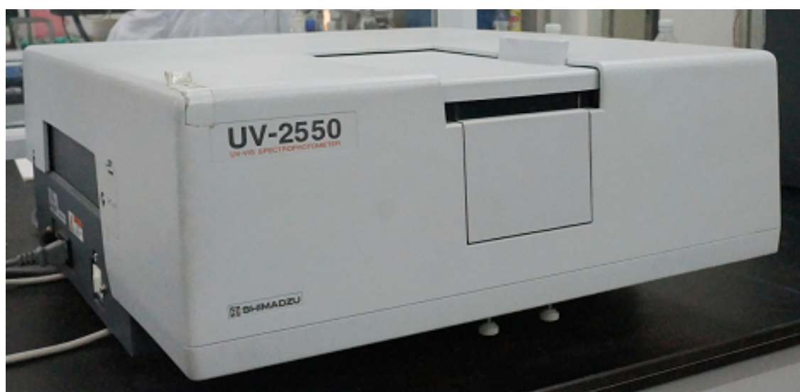
Figura 3.4: Espectrômetro modelo: UV-2550, empresa: Shimadzu. Espectro de absorção óptica na faixa de 190 nm a 1100 nm. Fonte: Silva (2011).
