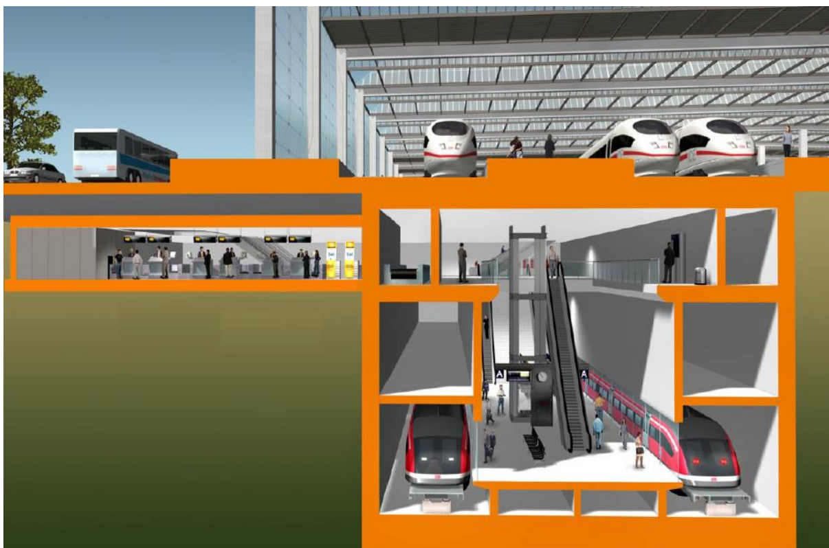
Figura 39 – Vista em corte da estação Maglev proposta para o aeroporto de Munique
