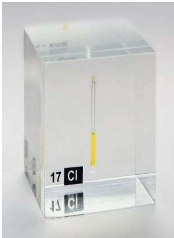
Figura 16: Cloro líquido selado em uma ampola de quartzo submetido a uma pressão maior que 7,4 bar.
