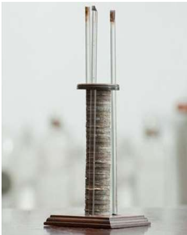
Figura 15: Pilha de Alessandro Volta em exposição na Royal Institution
