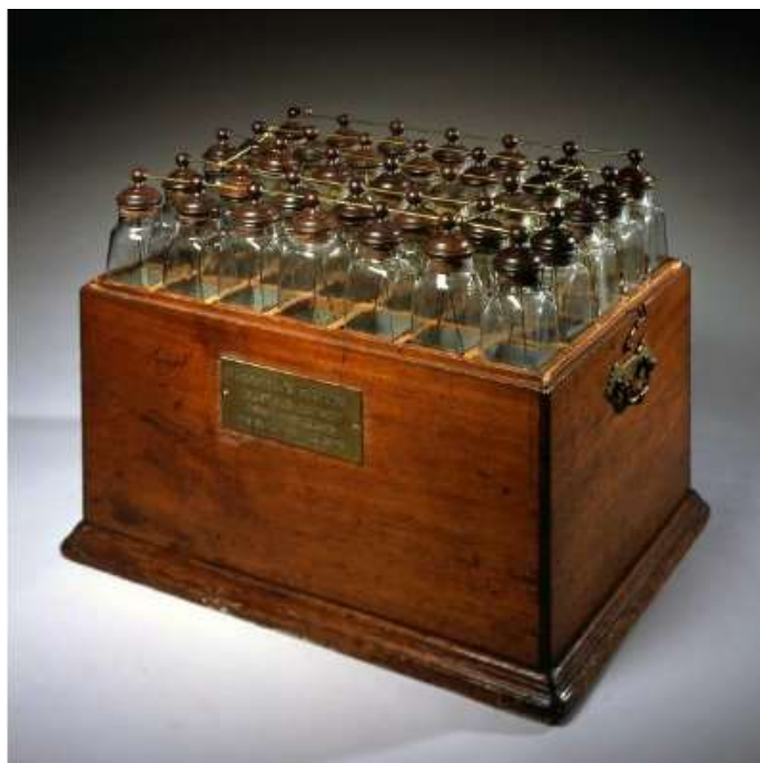
Figura 4: Bateria de 35 garrafas de Leyden organizadas em uma caixa de mogno
