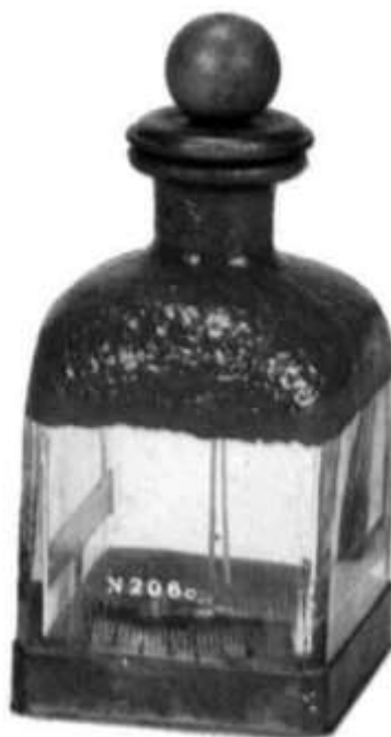
Figura 5: Eletrômetro de Palha desenvolvido por Alessandro Volta
