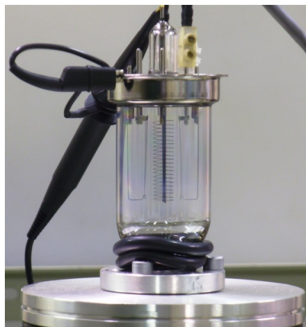
Figura 5.16 a) Esquema de um sensor tipo Bayard – Alpert [43]; b) Sensor Bayard – Alpert utilizado no sistema de vácuo do acelerador
