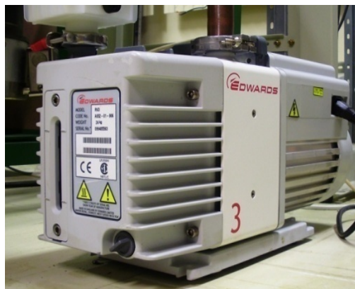
Figura 5.10 Bomba mecânica de palhetas rotativas utilizada no sistema de vácuo do acelerador
