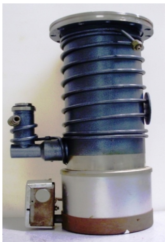
Figura 5.13 Bomba difusora fracionadora utilizada no sistema de vácuo do acelerador
