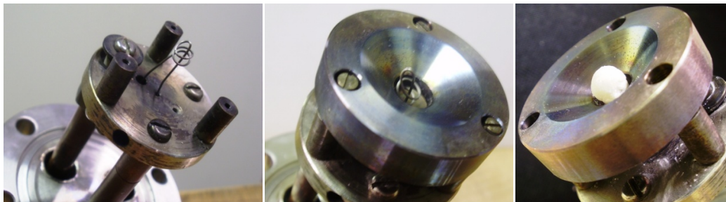
Figura 3.13 Porção superior do filamento emissivo localizado um pouco acima da extremidade inferior da abertura central do primeiro eletrodo do sistema de extração
