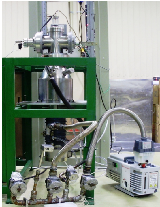
Figura 5.2 Estrutura constituída pela fonte termoiônica e pelos sistemas de vácuo e detecção
