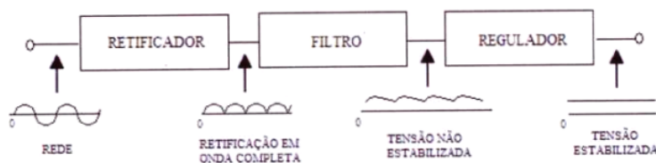
Figura 4.6 Diagrama de blocos de uma fonte de tensão regulada [34]
