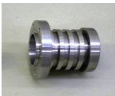
Figura 3.10 Cilindro metálico de conexão para a montagem do sistema de extração
