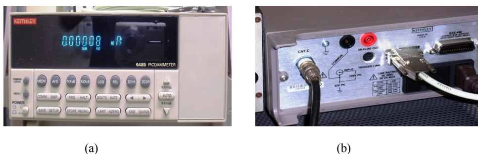
Figura 5.20 Painéis (a) frontal e (b) traseiro do picoamperímetro utilizado na medição da corrente iônica detectada (o cabo coaxial é conectado ao picoamperímetro através de uma conexão BNC situada no painel traseiro do medidor)
