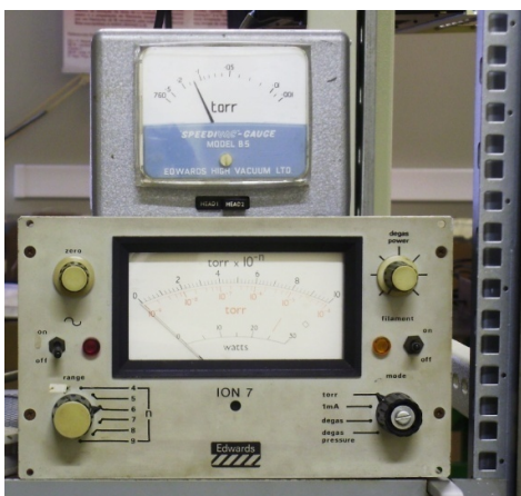
Figura 5.17 Escalas dos medidores Pirani (acima) Bayard – Alpert (abaixo)
