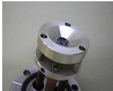
Figura 3.8 Cone metálico conectado acima da plataforma superior na estrutura interna da fonte termoiônica (primeiro eletrodo do sistema de extração)
