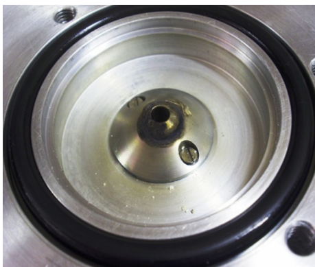
Figura 6.8 Mancha resultante do grande número de íons que colidiram com a periferia da abertura central do segundo eletrodo do sistema de extração
