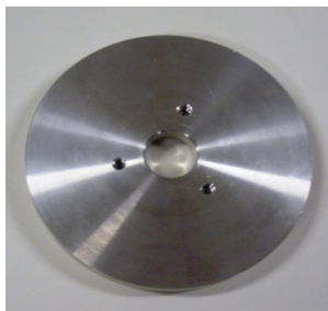
Figura 5.6 Disco metálico (13) para conexão do sensor do medidor de pressão Bayard - Alpert à câmara de detecção
