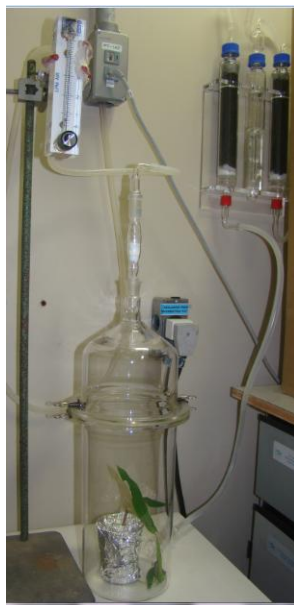
Fotografia 12. Câmara de vidro adaptada para aeração
