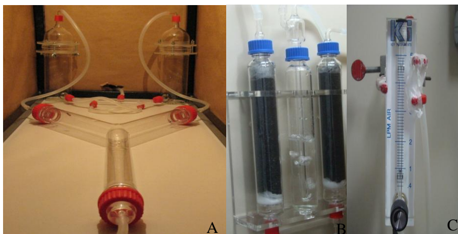
Fotografia 11. A) Olfatômetro em Y. B) Filtro com carvão ativado e água. C) Fluxômetro
