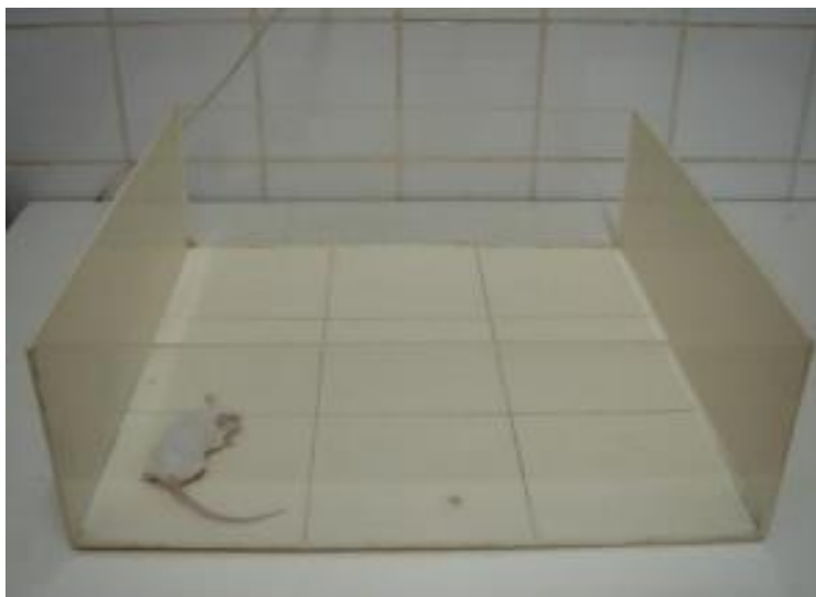
Figura 8: Imagem demonstrativa do aparato utilizado no experimento open-field
