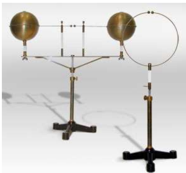
Figura 10. Um instrumento capaz de criar e detectar as ondas eletromagnéticas de Hertz.
