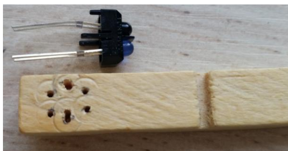
Figura A42 - Furos de fixação do sensor reflexivo no pregador de roupas.
