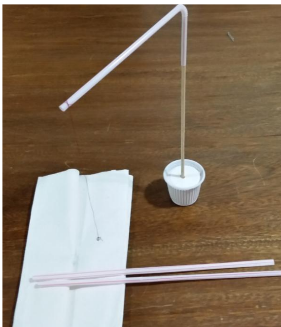
Figura 13 - Material da atividade investigativa de eletrostática. O eletroscópio, preso a um copo de café com gesso, canudos e papel para eletrização por atrito.
