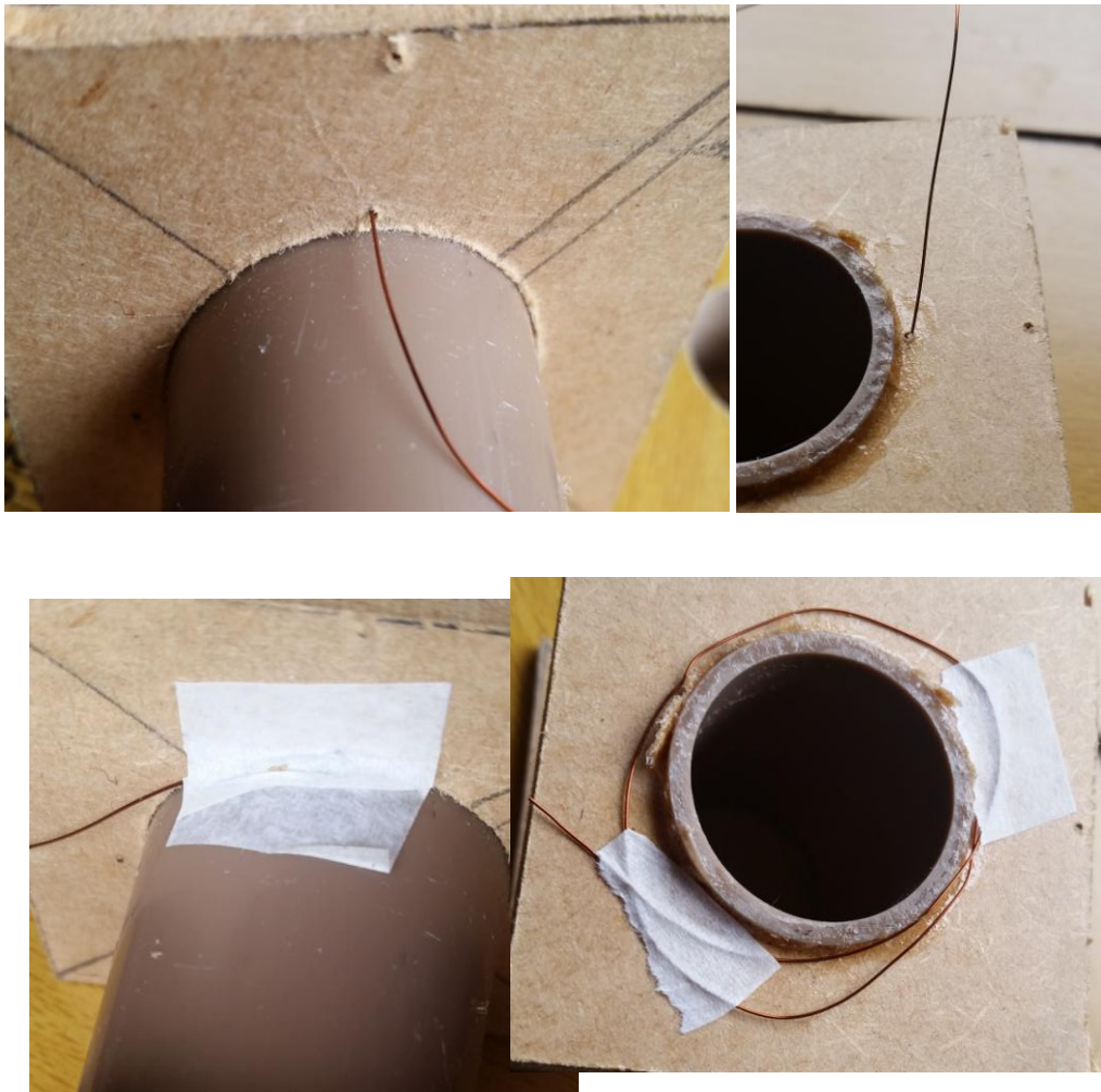
Figura A09 - Fio de cobre preso no carretel.
