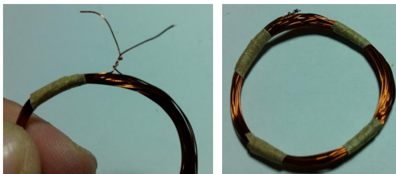
Figura A36 - Soldagem das pontas da bobina.
