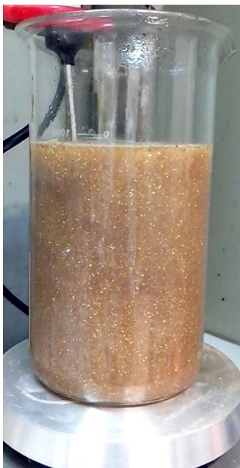
Figura 19 – Imagem mostra aspecto da síntese enquanto aquecida em uma hot plate . Em destaque, podemos ver a formação de cristais amarelos brilhantes, dispersados pelo líquido devido a agitação constante aplicada a ele.
