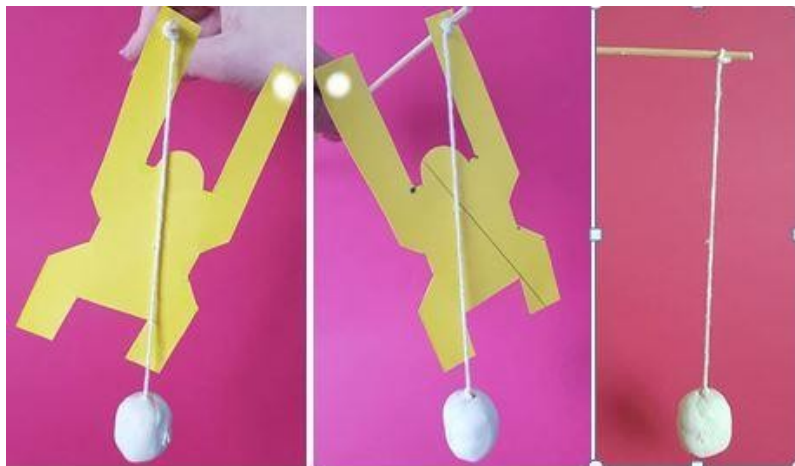
Figura 16 - Localização do centro de gravidade através do fio de prumo
